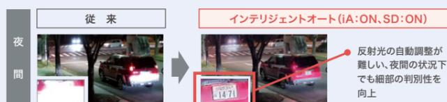
反射光の自動調整が難しい、夜間の状況下でも細部の判別性を向上
