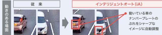
動いている車のナンバープレートのふれをシャープなイメージに自動調整
